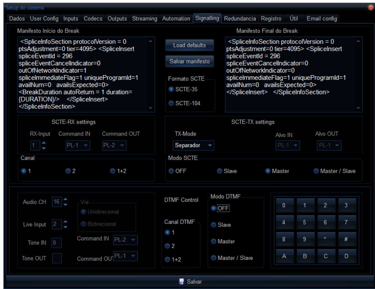
Figura - Sinalização SCTE-35/SCTE-104 e controle DTMF.
